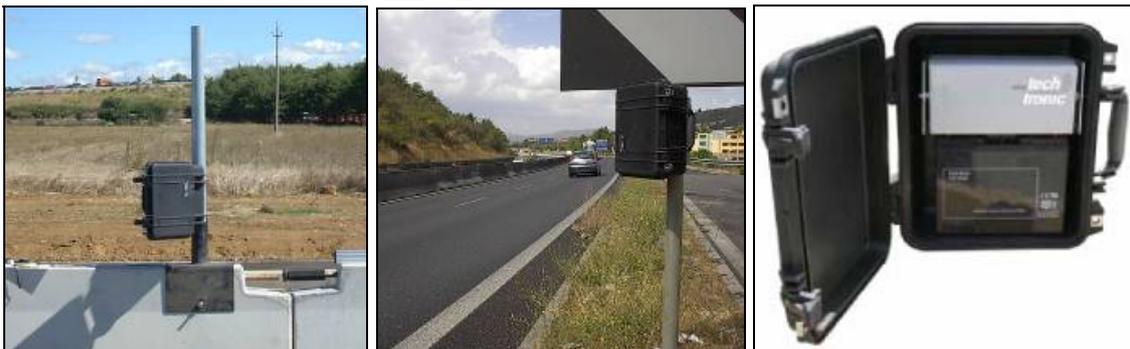
Figura 2.1.2 - Radar Techtronic Compact-1000 JR Portatile
