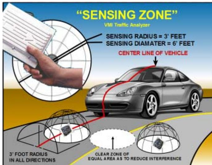
Figura 2.1.8. Area di copertura del sensore di rilievo
