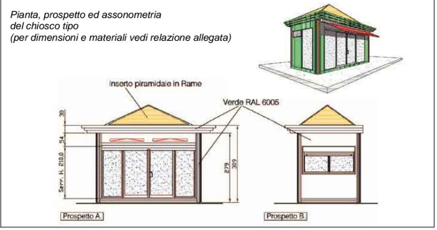
Il chiosco dovrà essere realizzato nelle dimensioni riportate nel presente piano e con strutture che utilizzino tipologie, colori e materiali coerenti con quelli previsti nell' abaco.
