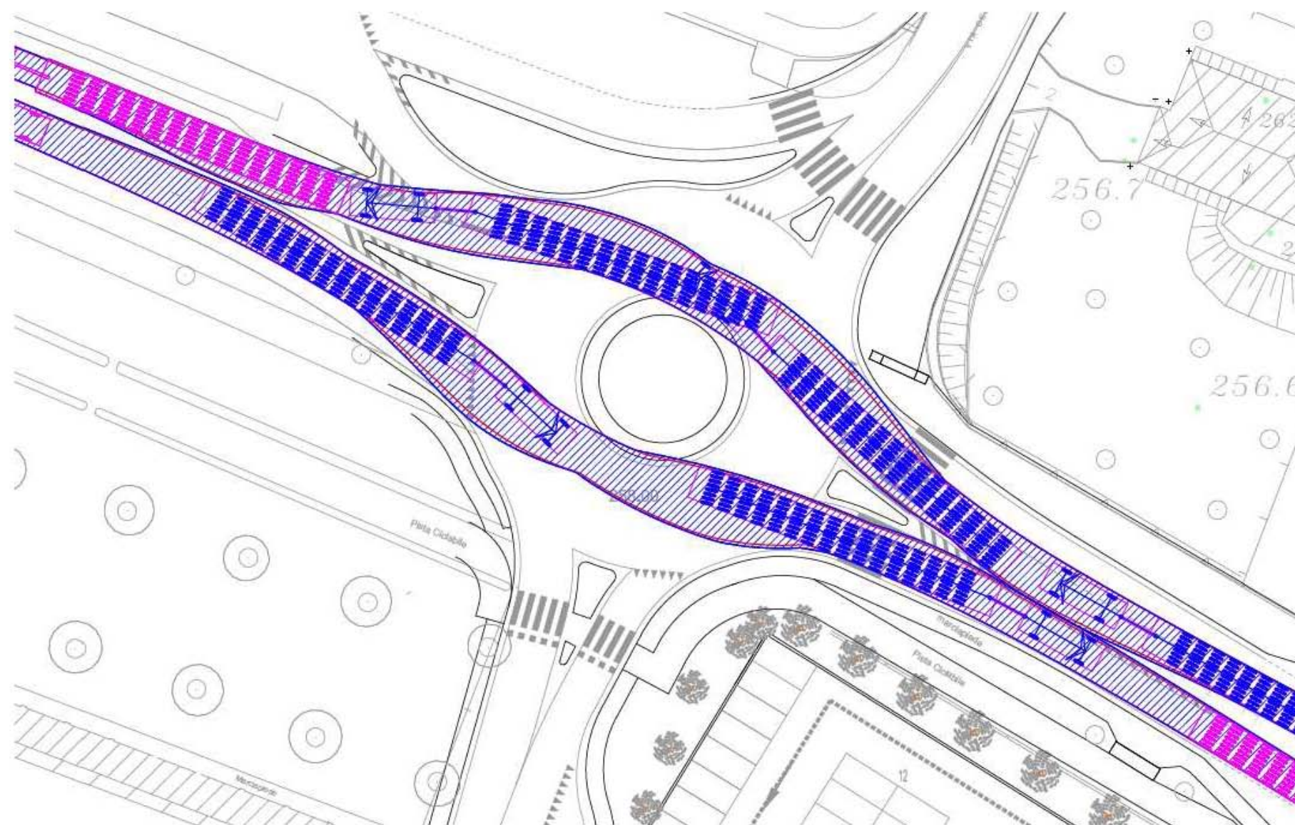
Figura 17 – Verifica dinamica manovre – TE 30,00 metri x 36,00 metri
