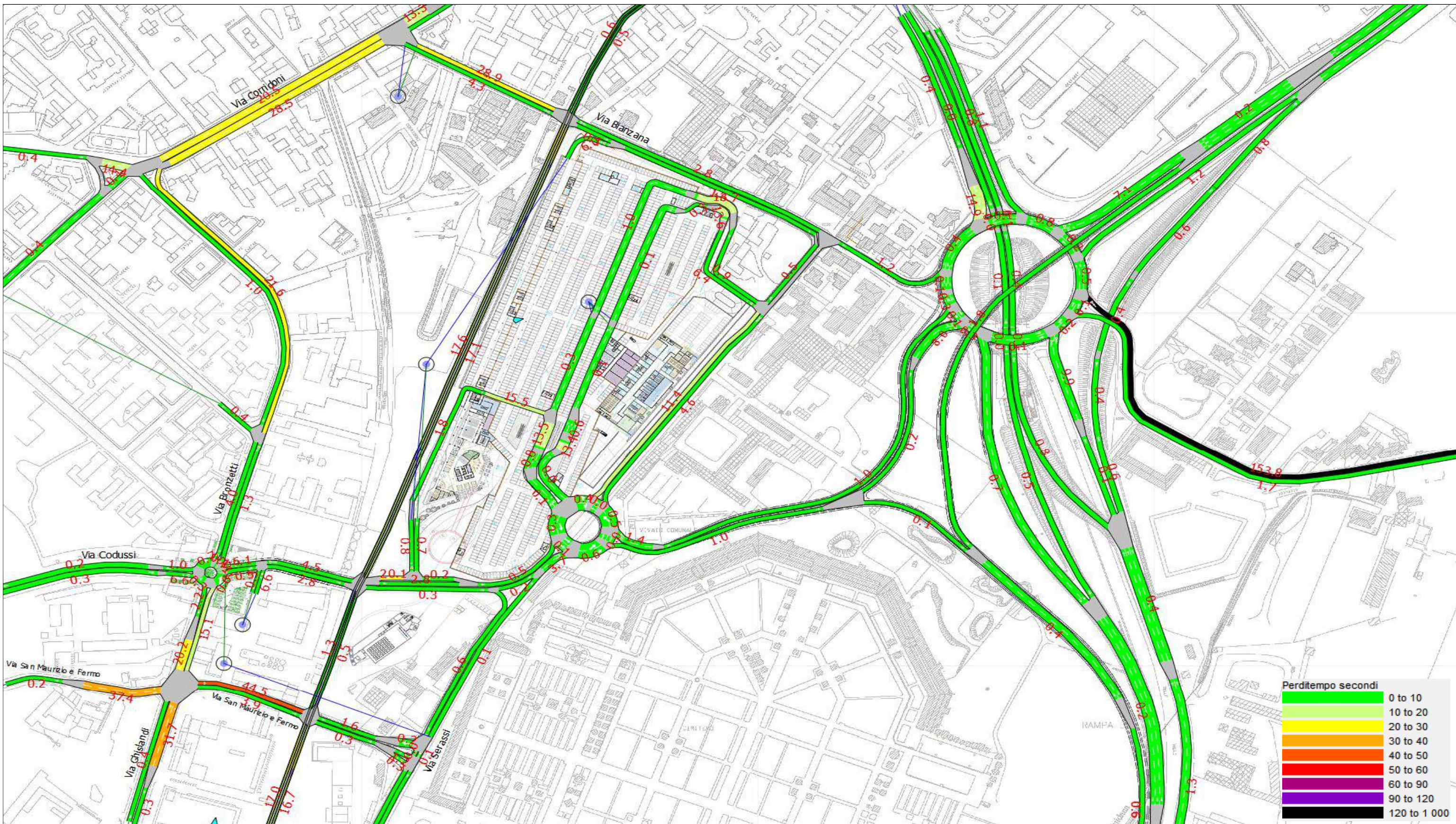
FIGURA 7.3.4.c -SIMULAZIONE DINAMICA - PERDITEMPO PER TRATTA - SCENARIO 1 DI PROGETTO - ORA DI PUNTA DEL VENERDI' POMERIGGIO 17.30-18.30
