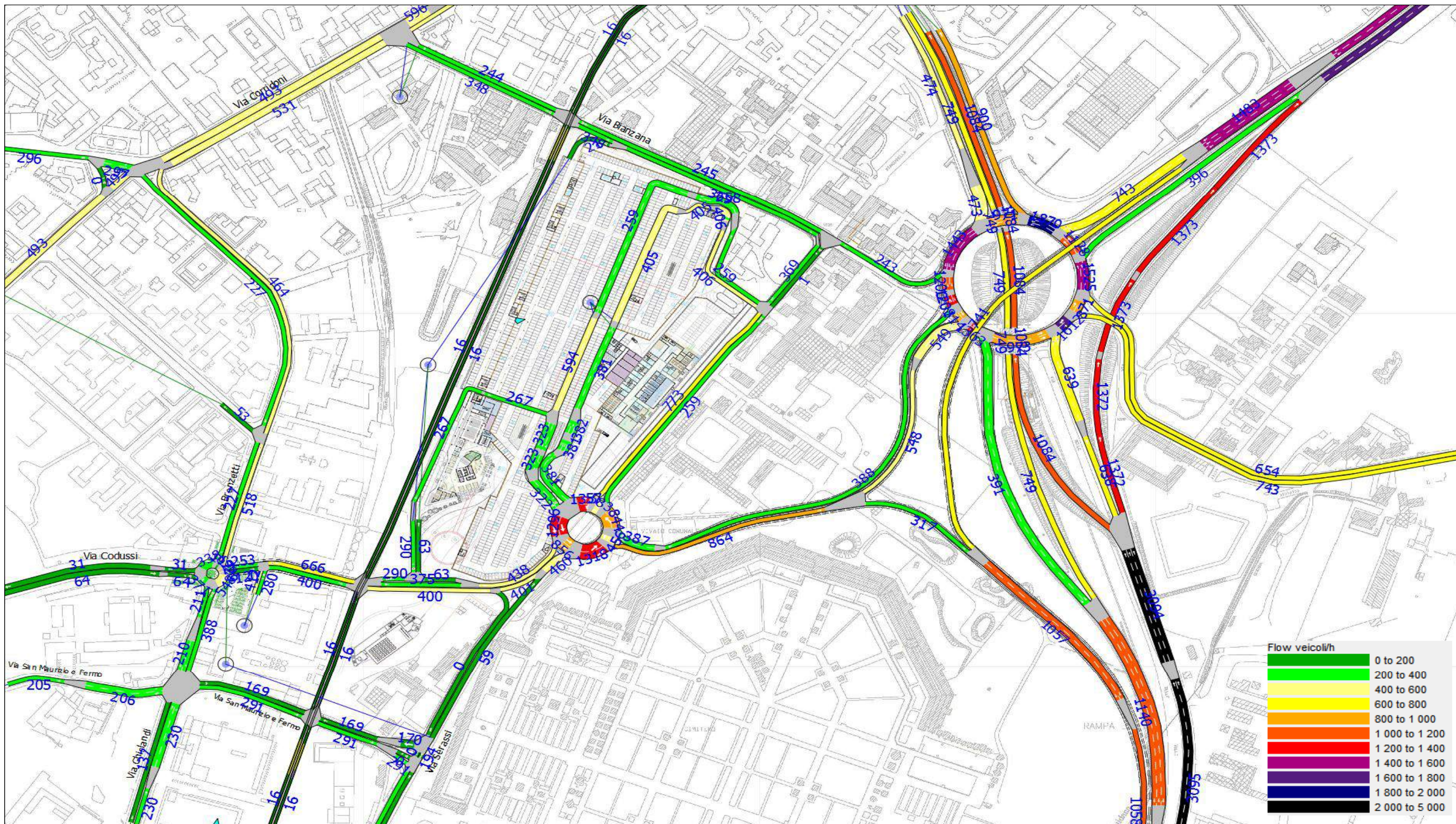
FIGURA 7.3.5.b - SIMULAZIONE DINAMICA - FLUSSI VEICOLARI - SCENARIO 1 DI PROGETTO - ORA DI PUNTA DELLA DOMENICA CON EVENTO SPORTIVO 17.30-18.30
