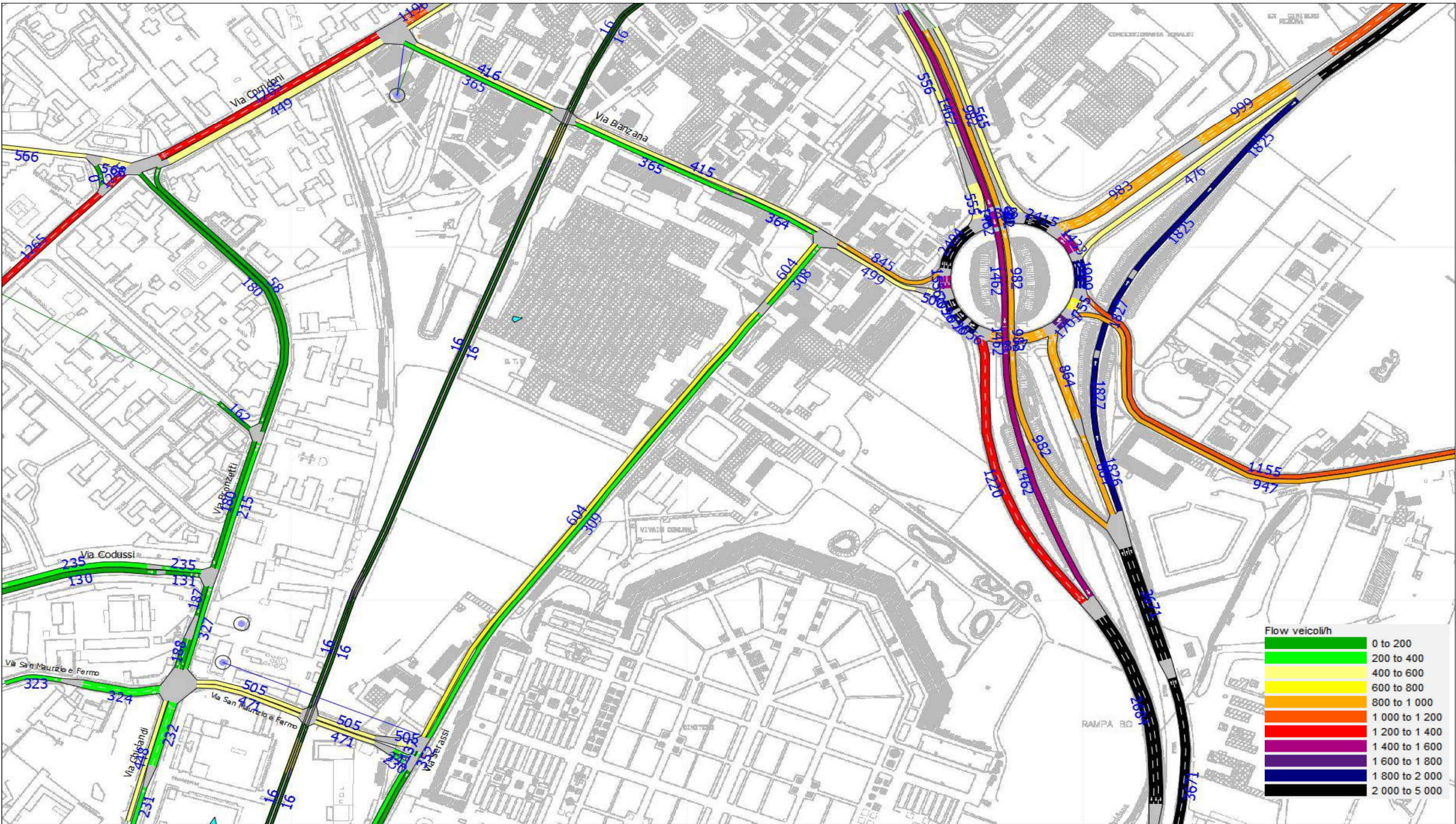
FIGURA 4.8.1.a - SIMULAZIONE DINAMICA - FLUSSI VEICOLARI - STATO DI FATTO - ORA DI PUNTA DEL MATTINO FERIALE 7.30-8.30
