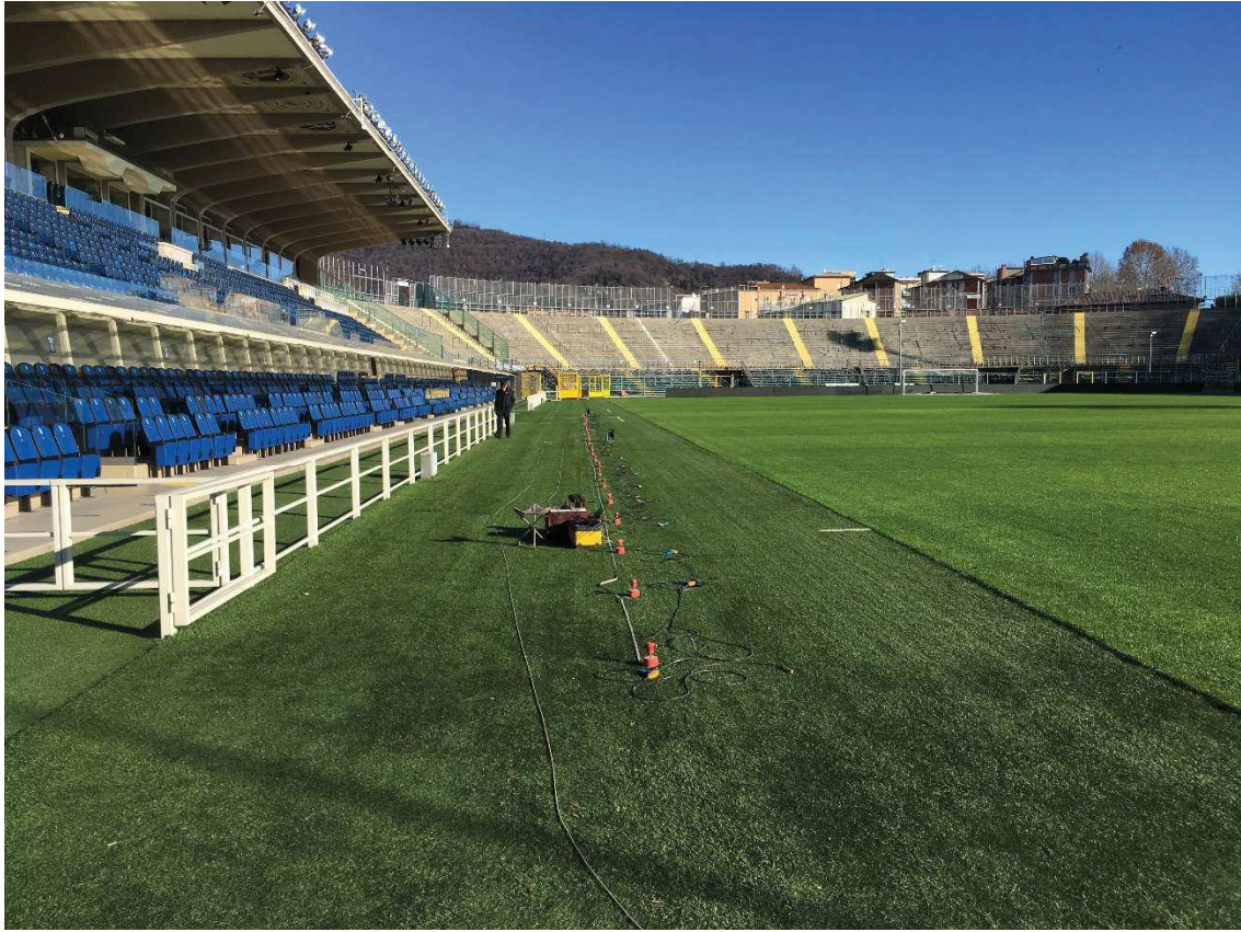
Stendimento MASW n° 1
