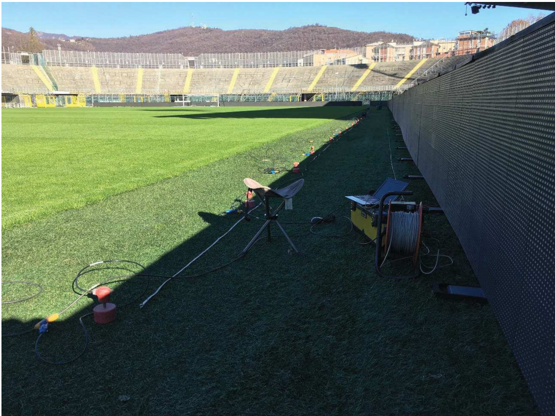
Stendimento MASW n° 2
