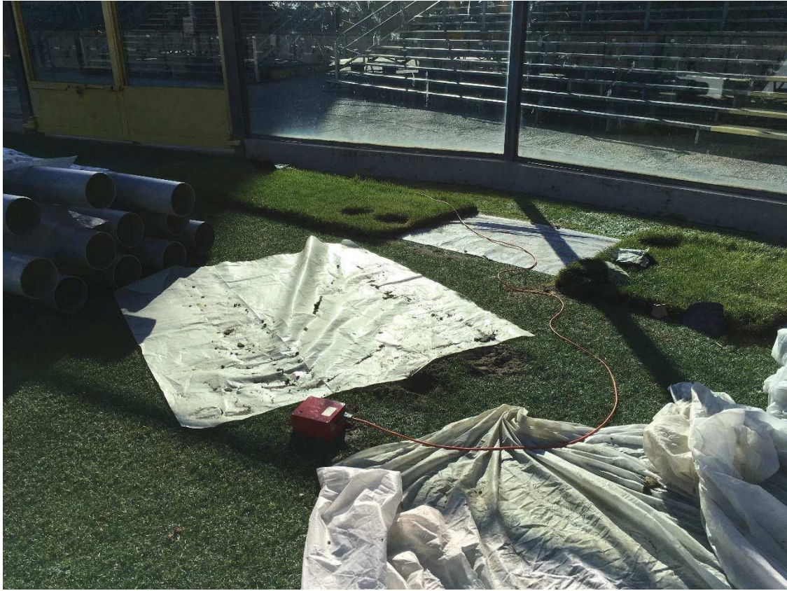
Prova con tromografo n°1
