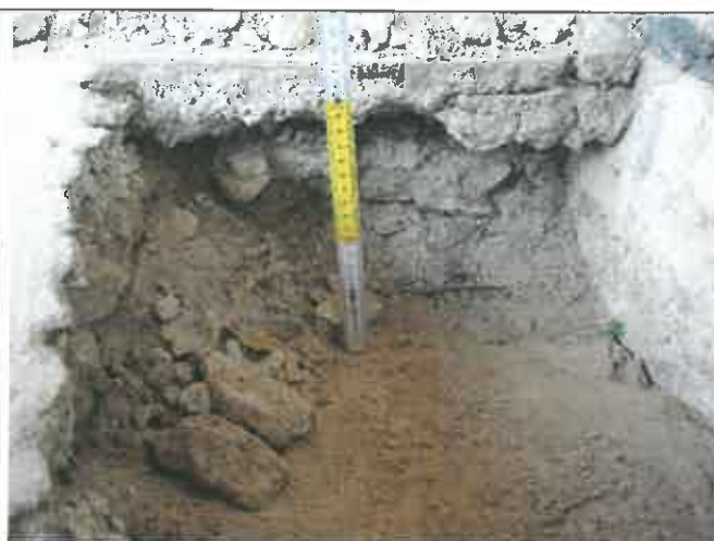
Particolare di un saggio effettuato per verificare lo spessore del riempimento e l'eventuale presenza di pavimentazioni, che non sono state rinvenute
