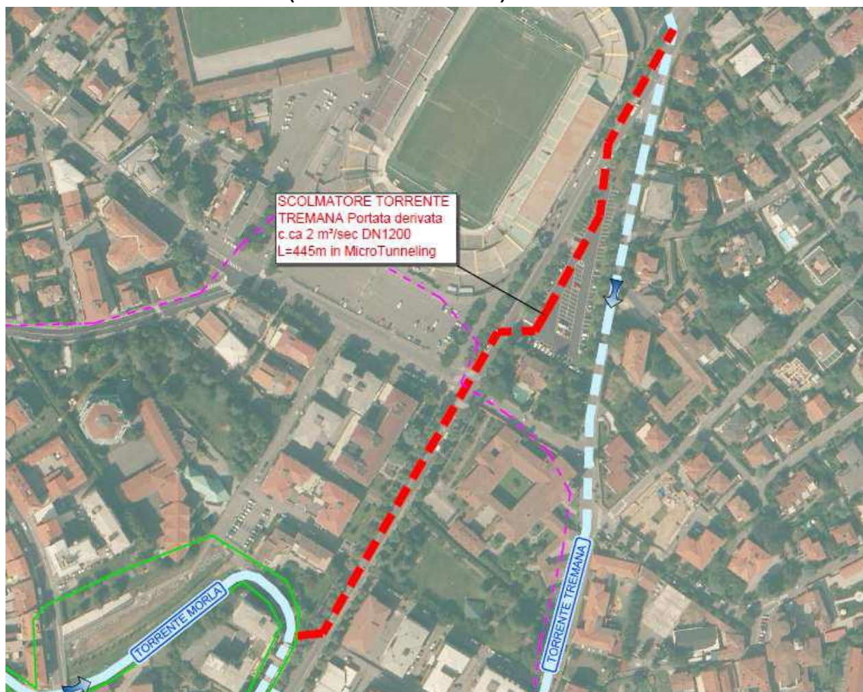
Figura 3.8 - Tracciato del diversivo del tratto tombinato del Torrente Tremana, a valle dell'incrocio tra Viale G. Cesare e Via Milazzo (in adiacenza allo Stadio)
