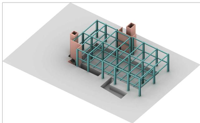
schema esemplificativo della "gabbia strutturale / spinte sismiche" finalizzata al consolidamento statico dell'edificio.
