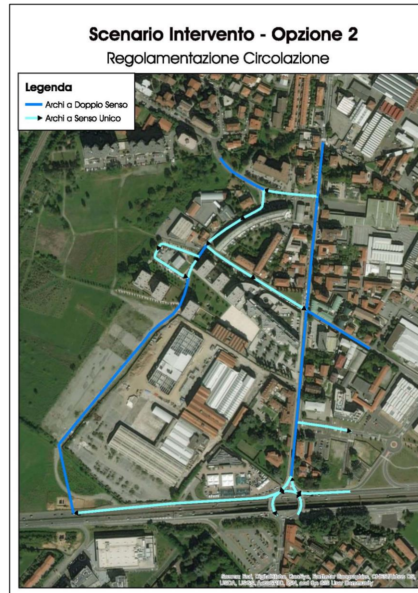
Figura 49 – Grafo della rete implementato per lo Scenario di Intervento – Regolamentazione Circolazione - Opzione 2
