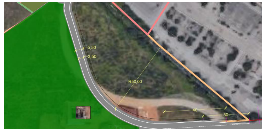
Figura 27 – Dimensionamento di massima della corsia di decelerazione – rampa in uscita dalla SS671 (accesso al PII Parco Ovest).
