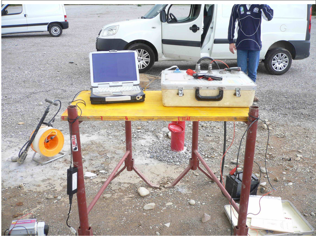
Fig. 19: Esecuzione down-hole in foro di sondaggio n°2
