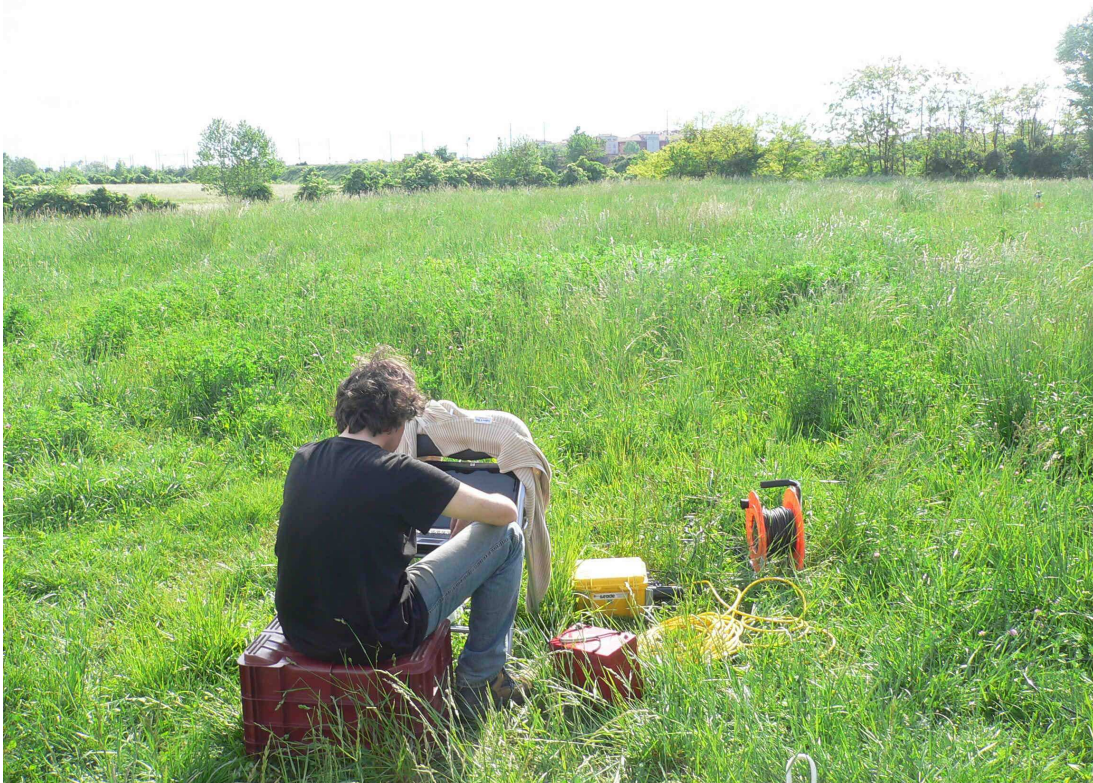
Fig. 20: Esecuzione sismica a rifrazione (area palestra)
