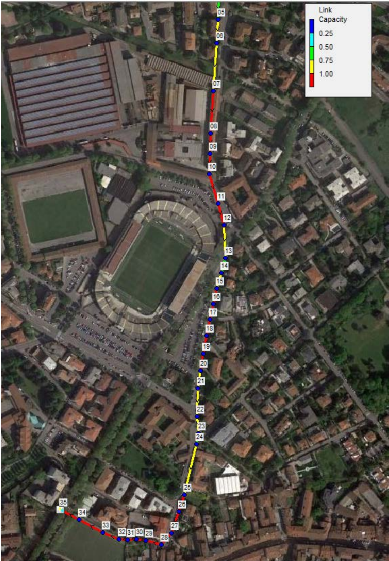
Figura 7.2: Grado di riempimento tombinatura T. Tremana con scarico nel T. Morla con Htr100.
