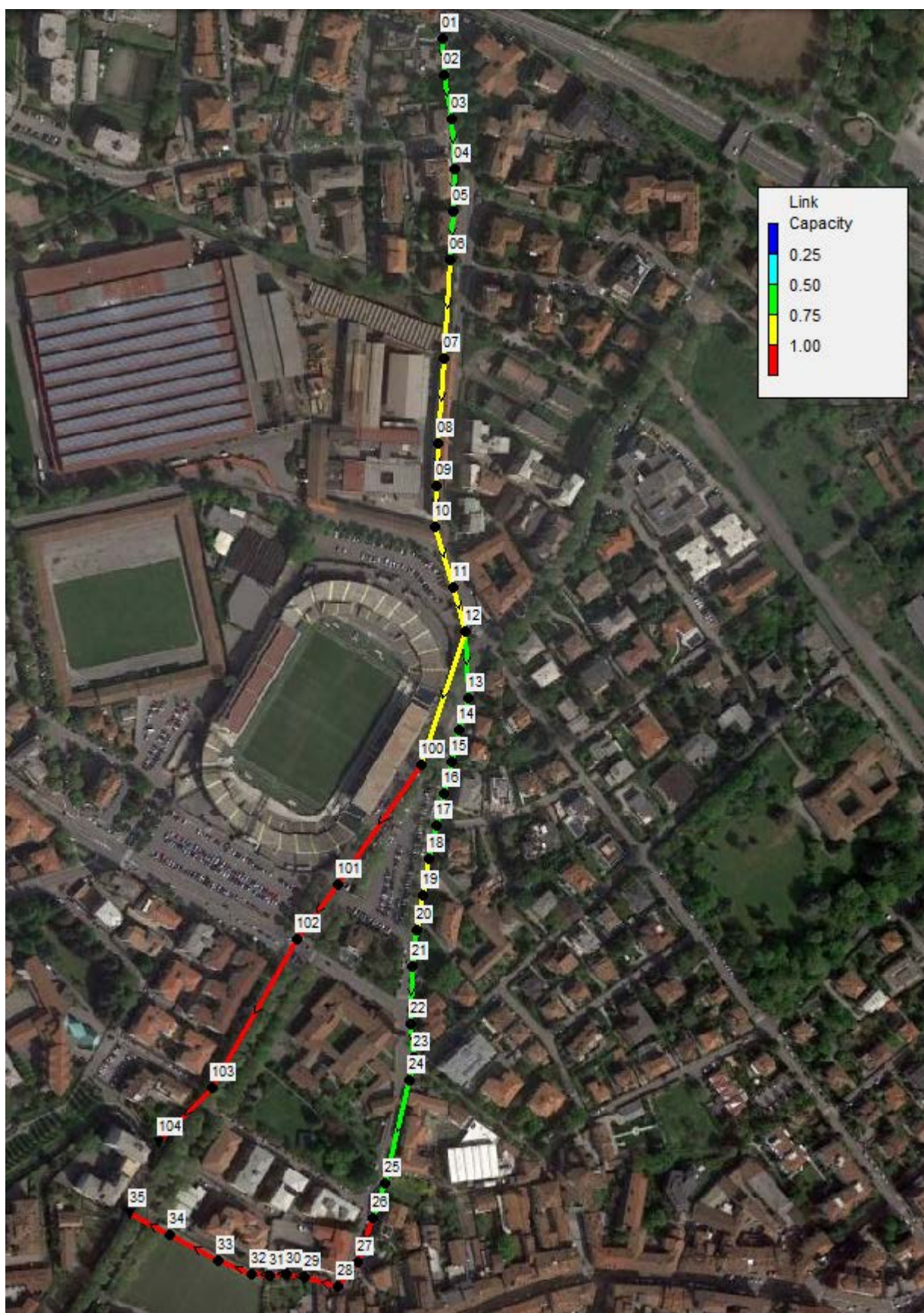
Figura 7.27: Grado di riempimento tombinatura T. Tremana con BYPASS - T. Morla idrogramma laminato Tr200.
