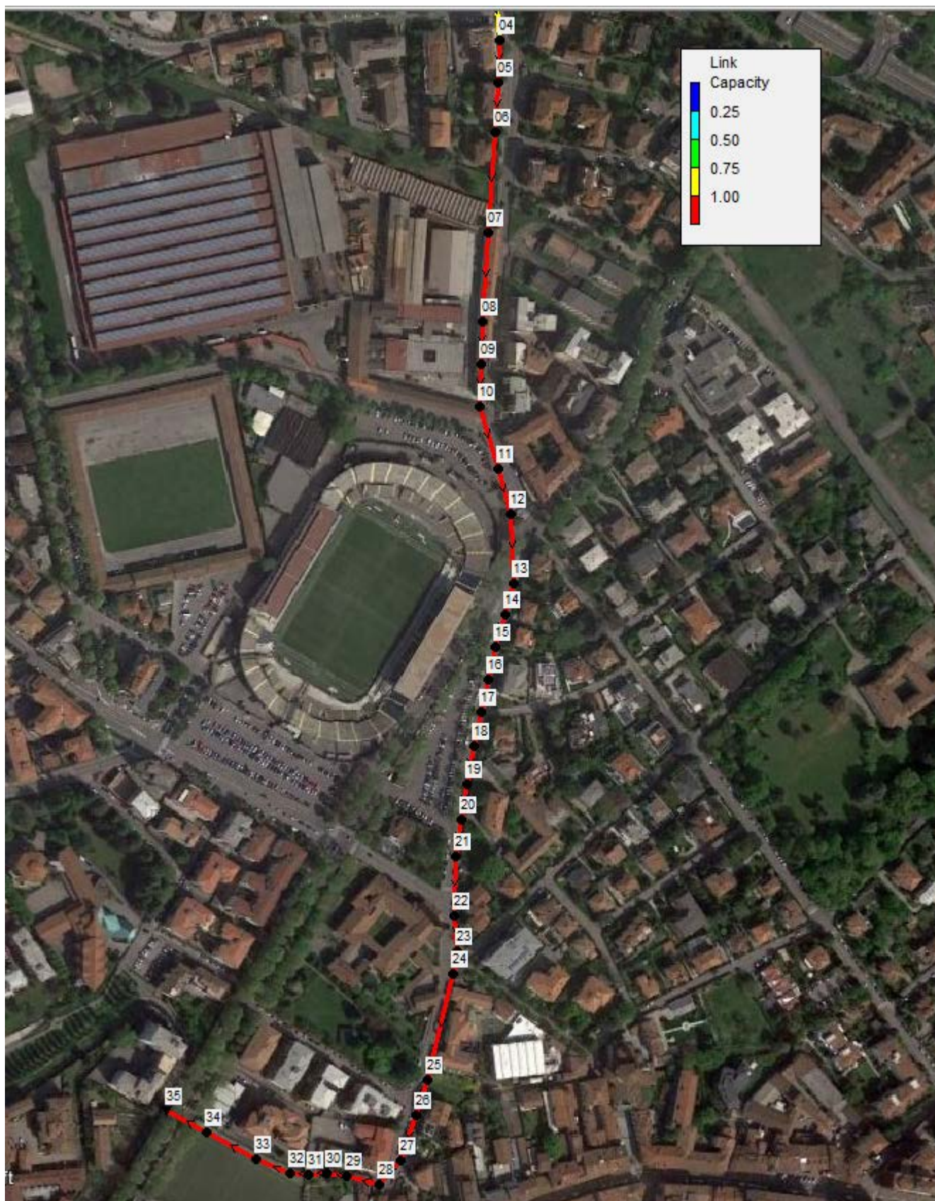
Figura 7.25: Grado di riempimento tombinatura T. Tremana con scarico nel T. Morla idrogramma laminato Tr200.
