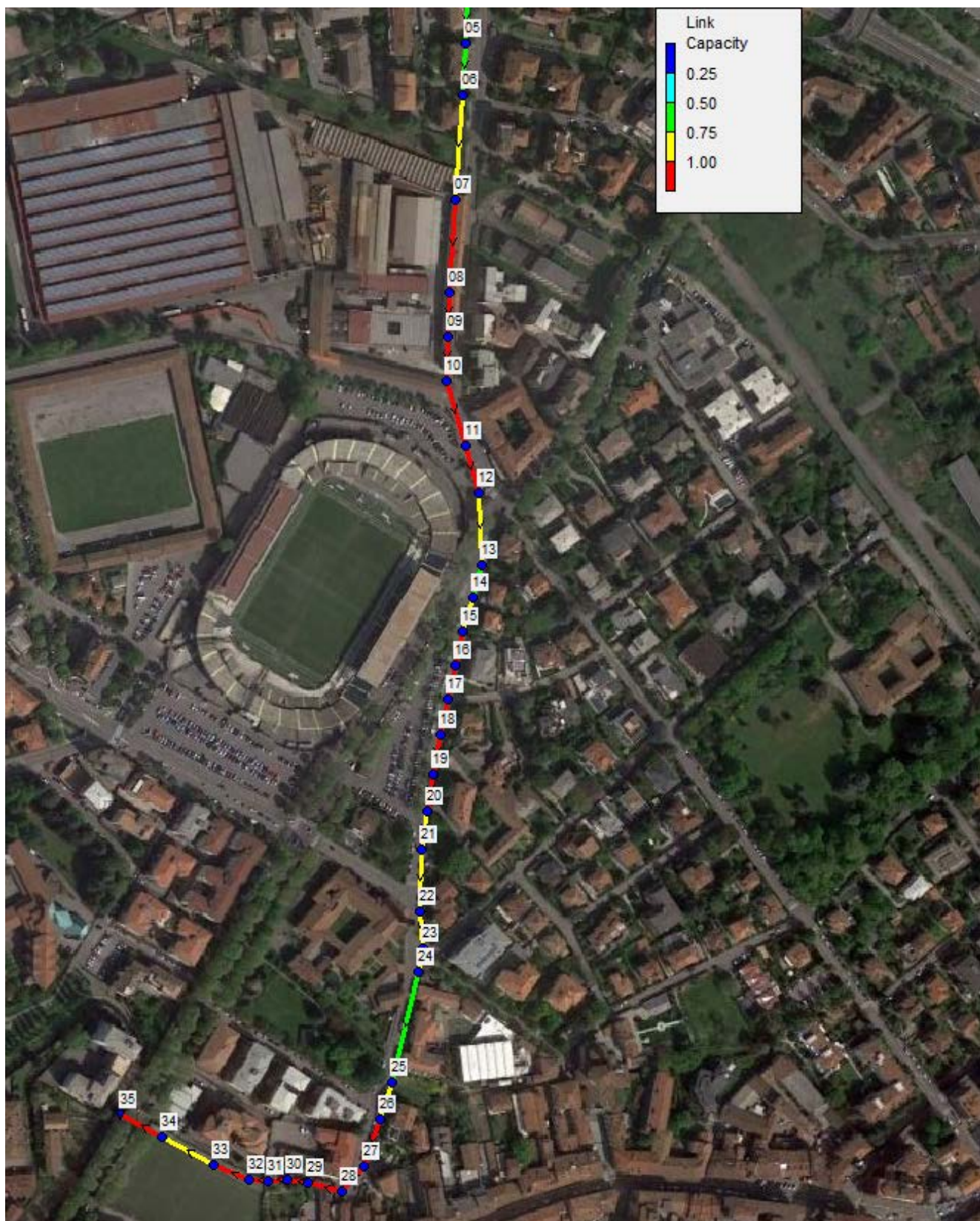
Figura 7.24: Grado di riempimento tombinatura T. Tremana con scarico nel T. Morla idrogramma laminato Tr100.
