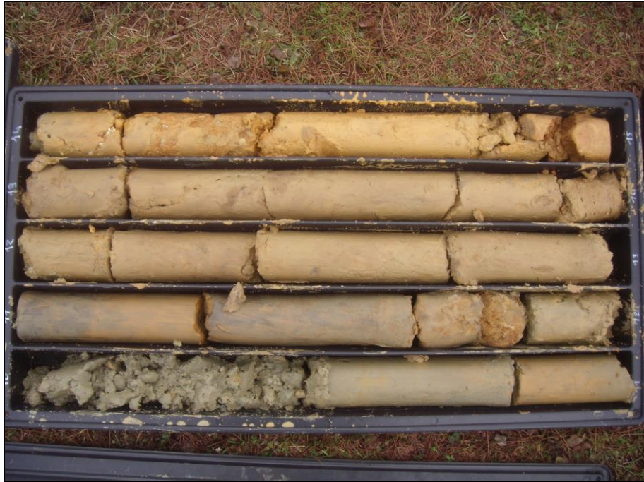
Cassetta catalogatrice del sondaggio meccanico n. 1 (10,0-15,0 m)
