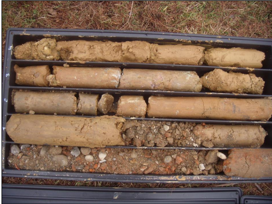
Cassetta catalogatrice del sondaggio meccanico n. 1 (0,0-5,0 m)
