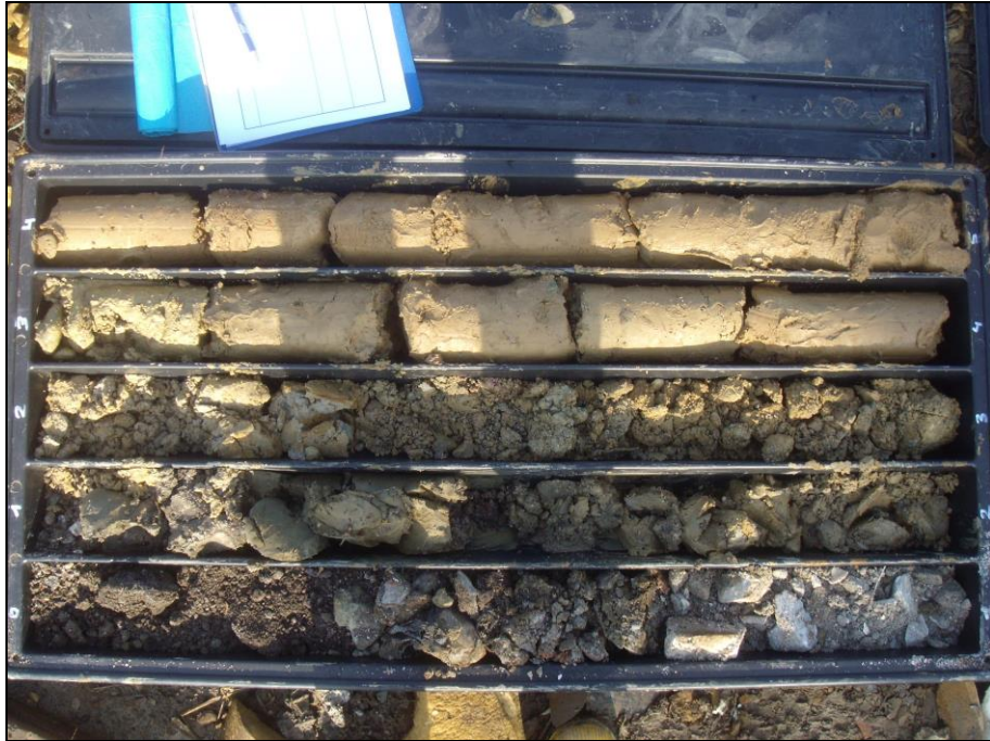
Cassetta catalogatrice del sondaggio meccanico n. 2 (0,0-5,0 m)
