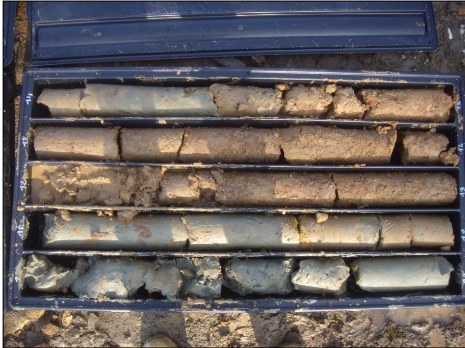
Cassetta catalogatrice del sondaggio meccanico n. 2 (10,0-15,0 m)
