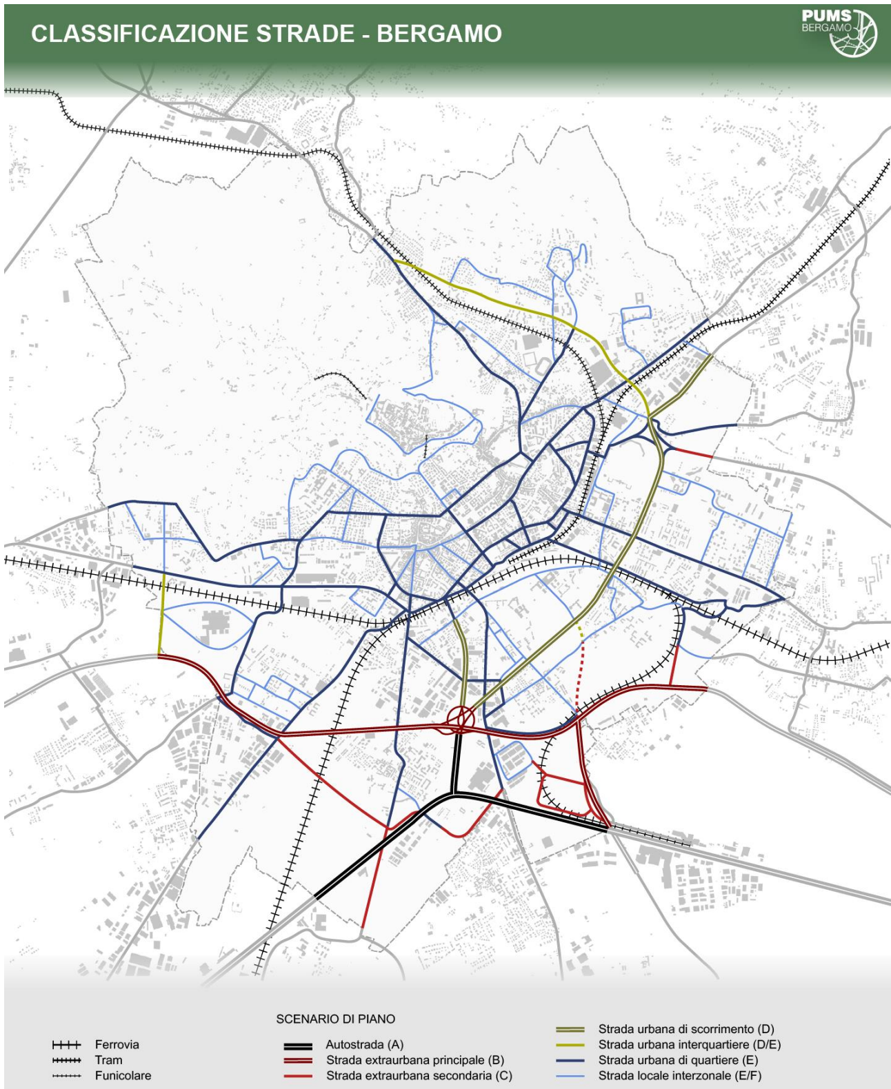
Figura 6-4: Classificazione funzionale della rete stradale
